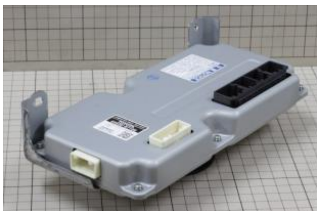
トヨタプリウス(4代目)搭載リチウムイオンバッテリーBMS
