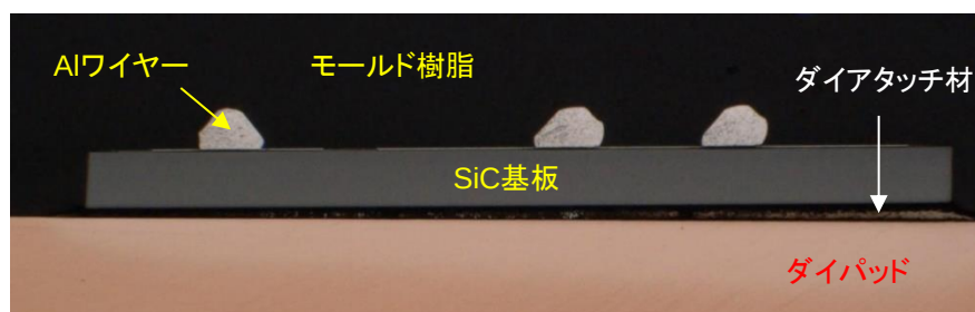
Fig. 2-1-7 チップ部拡大 断面OM像
