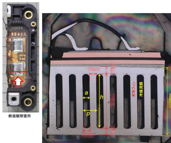
Fig. 4-1-4 冷却器断面OM像
