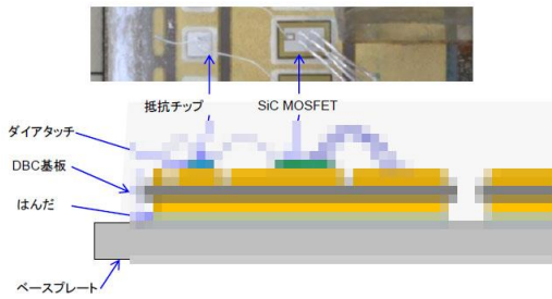
Fig. 3-2-1 モジュール断面模式図
