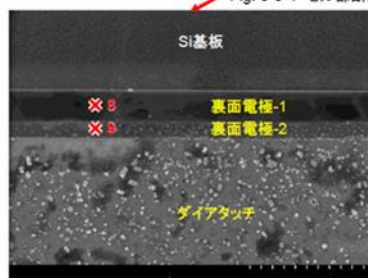
Fig. 3-3-5 裏面断面SEM像 (IGBT/FWD境界)
