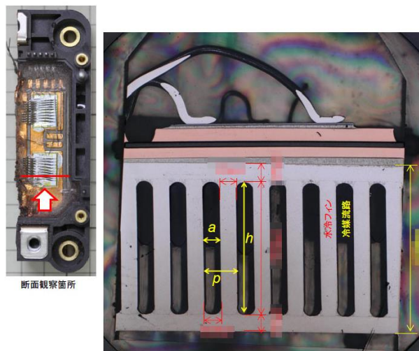
Fig. 4-1-4 冷却器断面OM像
