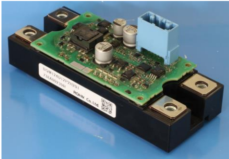
解析対象の車載昇圧用 SiCモジュール (BQM124D12P2H201)
