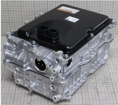
PCU外観写真
