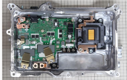
PCU内部(DCDCコンバータ)写真
