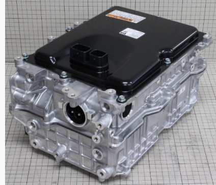
PCU外観写真
