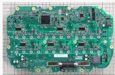
リア側インバータ基板
