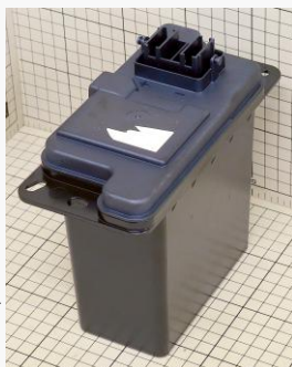
補機バッテリー外観
