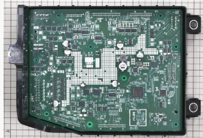
Xiaomi(小米) SU7 Max搭載 統合ECU(BCM RH) 内部
