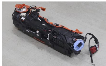
TESLA CYBERTRUCK搭載 DCジャンクションボックス製品外観
