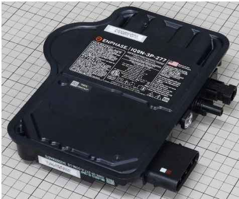
Enphase製マイクロインバータ (IQ9N-3P)
