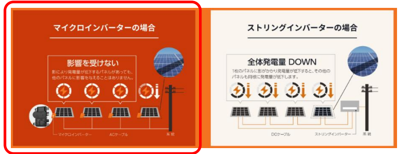
太陽光パネル-系統間イメージ図
