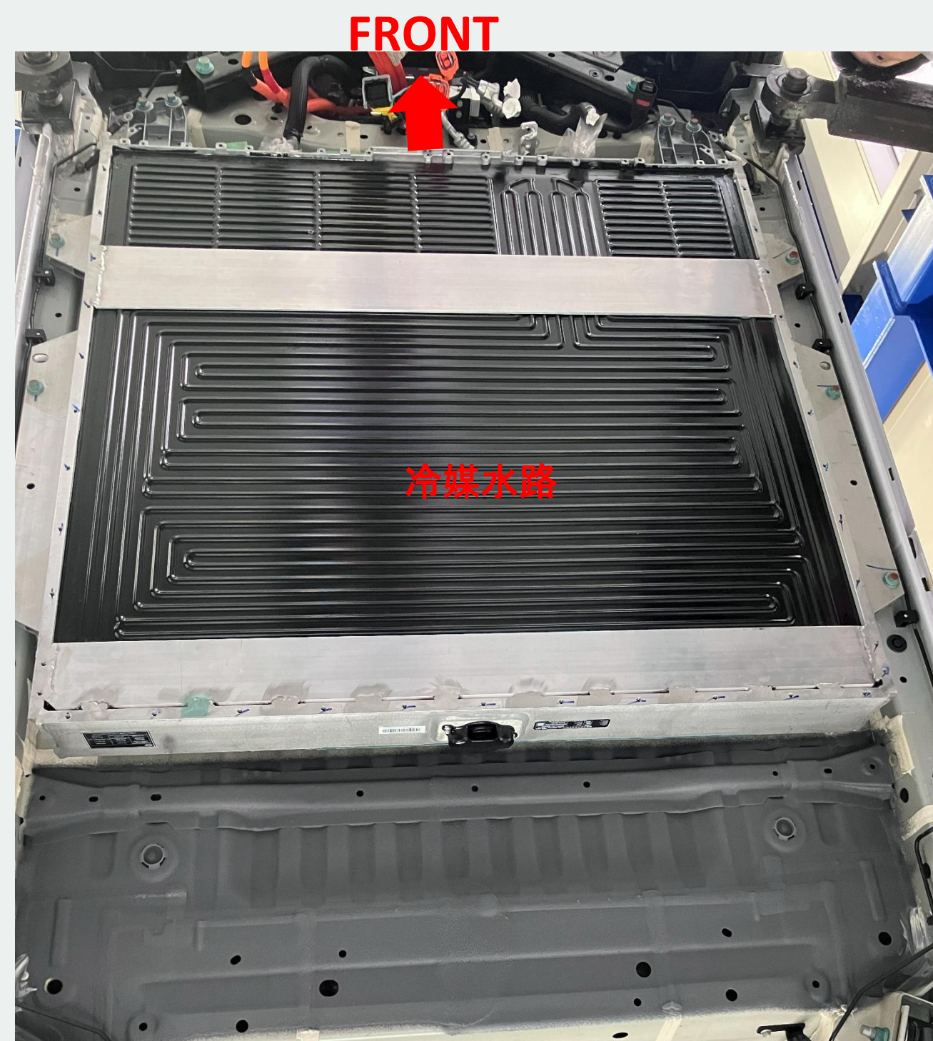
搭載電池パック（底面） ※カバー取り外し後
